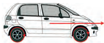
Рис. 11. Направление поступательного и вращательного движения на автомобиле «Матиз»
