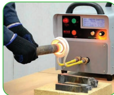
50-nji surat. Üsti ýokary ýygyllykly elektrik togunyň kömeginde taplamak
