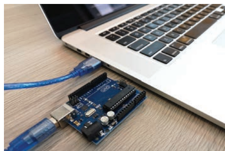
4-сурет. Бағдарламаны Arduino UNO платасына жазу
