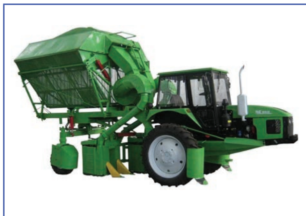
18-сурет. Тік шпиндельді МХ-1.8 мақта жинау машинасы
