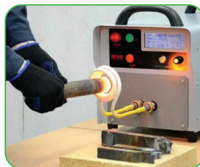
50-сурет. Бетті жоғары частоталы электр тогы көмегінде ширату
