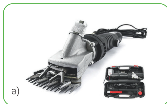
32-сурет. Қойдың жүнін қырқу құралдары: а) қайшы; ә) электр машинка
