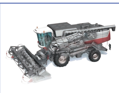
20-сурет. Астық жинау комбайндары: а) дән жинау үдерісіі; ә) "Торум 740"комбайн; б) Осьтік айналмалы фрезерлік (ажырату) аппараты.
