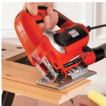
38-сурет. Электр лобзик кесу бұрышының ауып кетуі
