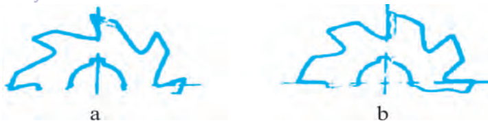
35-rasm. Frezerlarshakli: a) oʻtkircharxlangantishli, b) zatilovanniy.
