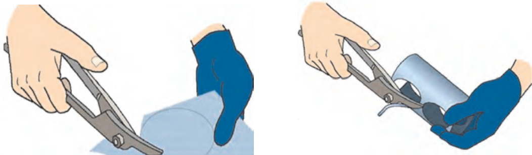
49-rasm. Qo'l qaychi bilan yupqa list materialni qirgqish.
