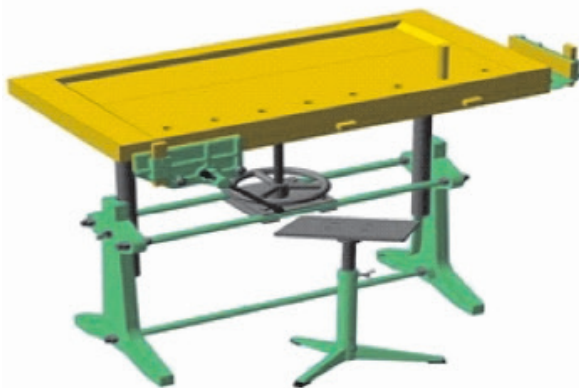
Расми 7. Дастгоҳи дуредгарӣ: 1 – асос; 2 – дастгир; 3 – мизи корӣ; 4 – хонаҳои кӯмакрасон; 5 – чойи коркард; 6 – пайвастаҳои ёрирасон; 7 – исканча.
