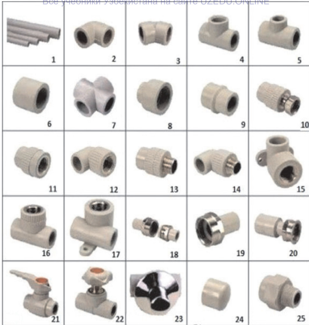
Расми 21. Ускунаҳои махсусе, ки ба кубурҳои пластмассагӣ гузошта мешаванд: 1 – кубур; 2 – пайвастунаки 90°; 3 – пайвастунаки 120°; 4, 5 – соҳатаксимкунак; 6 – пайвастунаки рост; 7 – соҳатаксимкунаки рост; 8, 9 – пайвастунаки тағйир додани андоза; 10, 11 – пайвастунаки берунаи оҳану пластмассагӣ; 12 – пайвастунаки берунаи 90°-и оҳану пластмассагӣ; 13 – пайвастунаки дохилаи рости оҳану пластмассагӣ; 14, 15 – пайвастунаки дохилаи 90°-и оҳану пластмассагӣ; 16, 17 – пайвастунаки соҳатаксимкунаки дохилаи 90°-и оҳану пластмассагӣ; 18, 19, 20 – пайвастунаки берунии оҳанӣ, 21, 22 – калида пластмассагӣ; 23 – пайвастунаки оҳанӣ; 24 – сарпӯш; 25 – сарпӯши тобдиханда.
