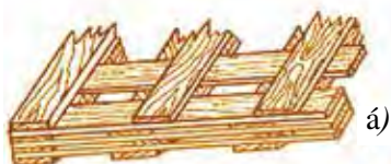
2-súwret. Taxtaylardı taqlaw: a) jasırıp; á) bir-birinen qashırıp; b) reykalardıń ústine.
