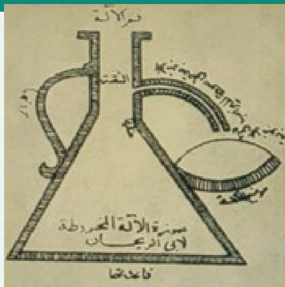
Абу Райхан Беруний, «Минералогия». IX кылым. Сууга салынган үлгү тарабынан сыгып чыгарылган суюктуктун көлөмүн аныктоочу прибордун чиймеси.
