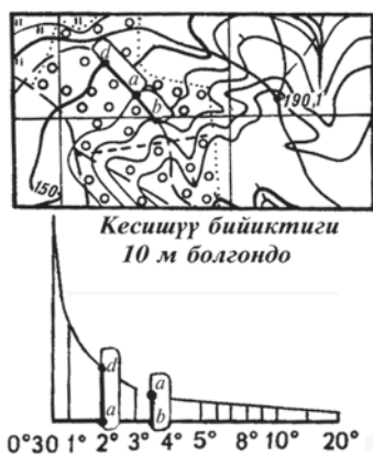
8-сүрөт. Бийиктиктер шкаласынанан капталдардын бийиктигин аныктоо.
