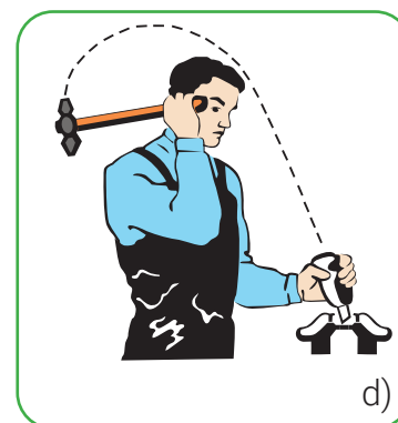
43-rasm. Bolg'a bilan zarb berish usullari: a) panja zarbi ; b) tirsak zarbi ; d) yelka zarbi .
