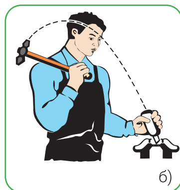
Рисунок 43. Способы нанесения ударов молотком: а) кистевой; б) локтевой; в) удар плечом.
