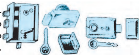
Расми 84. Қулфҳои пӯшида: а – қутишакл; б – муҳофиздори ду бор ҷарҳзанандаи қутишакл; в – қутишакли дорои сурма ва муҳофиз.
