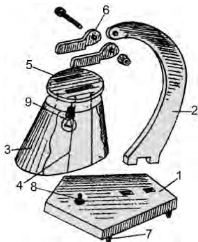
Расми 78. Лампаи мизӣ: 1 – тиргак (асос); 2 – танба; 3 – қабати Ҳимояи нурафкан; 4 – мавҷафкан; 5 – доираи аз фанер сохташуда; 6 – дастакҳои плафон; 7 – пояҳои тақягоҳ; 8 – калид (васлкунак); 9 – лампочка ва патрон.
