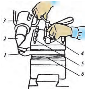
Расми 54. Теги харротиро ба дастаки теғ насб кардан: 1 – теғ; 2 – маркази баъдина; 3 – пиноли бабкаи баъдина; 4 – калид; 5 – винтҳои саҳтқунии теғ; 6 – тиргакҳои теғ.
