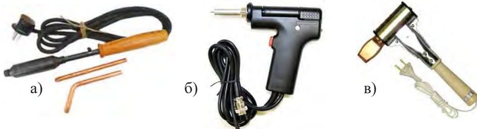
Расми 77. Кафшеркунандаҳо: а – оддӣ; б – пистолетмонанд; в – болқамонанд.
