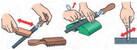
Рис.14. Методы очистки напильника.
