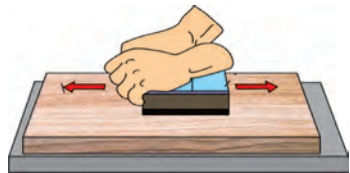
Рис.17. Шлифовка поверхности изделия.
