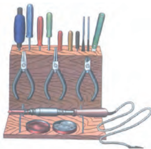
Рис. 75. Поддон для паяния, а также расположение посуды для припоя и флюсов на рабочем столе.
