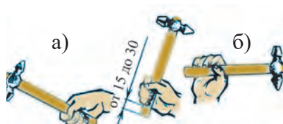
Рис.65. Способы держания молотка при резании: а – не зажимая пальцами; б – сжав пальцы.
