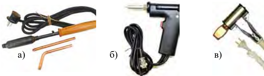
77-сурет. Дәнекерлеуіштер: а – қарапайым; б – пистолет сияқты; в – балға сияқты
