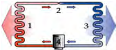
4-сурет. Тоңазытқыштың істеу схемасы.
