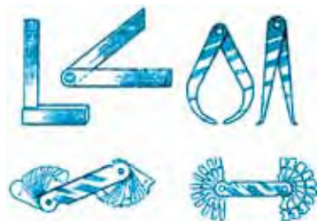
42-сурет. Шкаласыз өлшеу аспаптары: а – үшбұрышты сызғыш; б – малка; в – кронциркуль; г – нутромер, д – радиус шаблондары; г – резба шаблондары.
