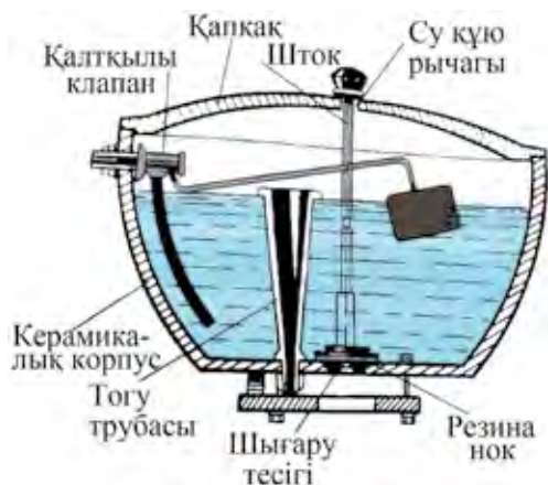
81-сурет. Су құю багінің түзілісі.
