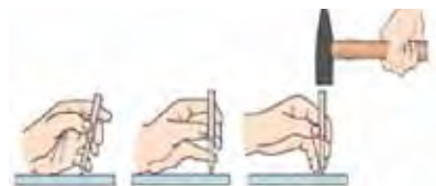
64-сурет. Плитаның үстінен кесуде зубиланы ұстау әдістері
