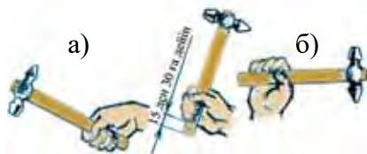
65-сурет. Кесуде балғаның сабын ұстау әдістері: а – бармақтарды сықпай; б – бармақтарды сығып.
