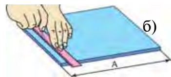
43-сурет. Сызу: а – циркульмен сызу; б – кернермен сызу.
