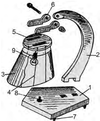
78-сурет. Үстел лампасы: 1 – астар (баған); 2 – тірек; 3 – қайтарғыштың қорғау бөлігі; 4 – қайтарғыш; 5 – фанерден жасалған шеңбер; 6 – плафон тұтқыштары; 7 – тірек аяқтар; 8 – кілт (үзіп-ұлағыш); 9 – лампочка және патрон.
