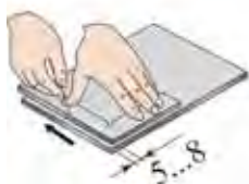
45-rasm. Tunuka listlarni tekislash qoidalari.
