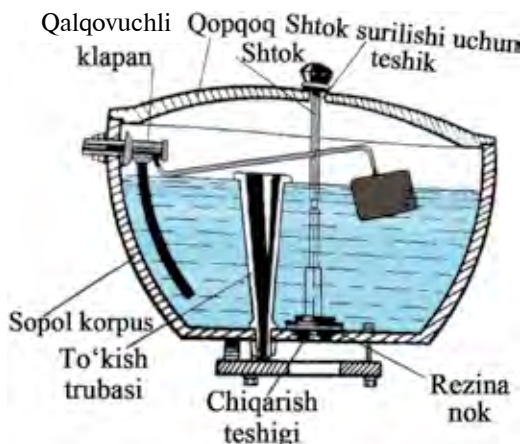
81-rasm. Suv quyish baki-ning tuzilishi.
