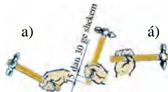
65-súwret. Kesiwde shókkishtıń sabın uslaw usılları: a) barmaqlardı qıspay; á) barmaqlardı qısıp.
