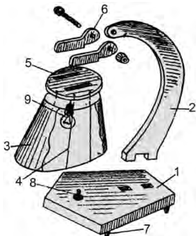
78-súwret. Stol lampası: 1—astına qoyatuǵın (tiykar); 2—tirgek; 3—qaytarǵıstıń qorǵanıw qatlamı; 4—qaytarǵısh; 5—fanerden islen-gen sheńber; 6—plafon tutqıshları; 7—tayanısh ayaqlar; 8—gilt (úzip-jalǵaw); 9—lampochka hám patron.
