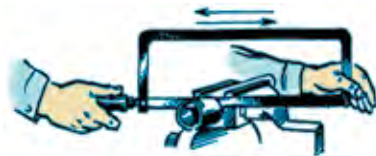
60-súwret. Trubalardı temir ustasınıń pıshqısı menen kesiw.
