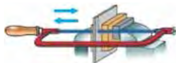
59-súwret. Uzun zagotovkalarđı polotnonıń 90° múyesh astında burıp pıshqılaw.
