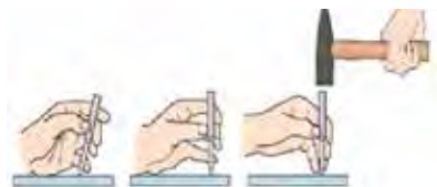
64-súwret. Kesiwde balǵanıń sabın uslaw usılları: barmaqlardı qıspay; barmaqlardı qısıp.
