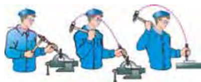
66-nji surat. Çekiç bilen urmak: a – penje urma; b – tirsek urma; ç – egin urma.
