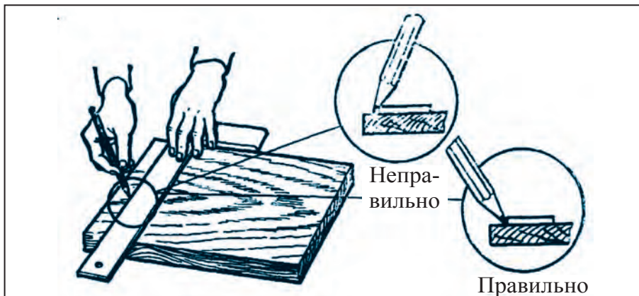
Рис. 41. Проведение линий при помощи угольника.
