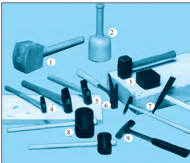
Рис. 13. Слесарные молотки и деревянная колотушка: 1, 2 – деревянные молотки; 3, 4, 5, 6, 7 – стальные молотки; 8, 9 – пластиковые (пластмассовые) молотки.
