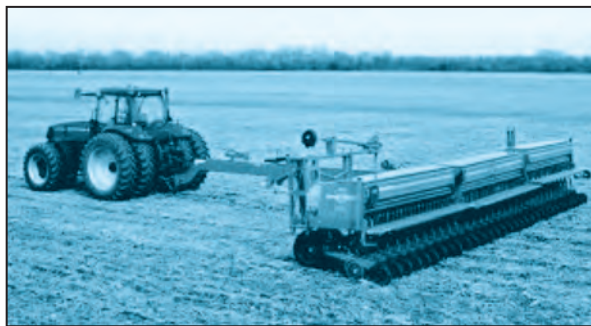
Рис. 12. Машина для посева семян – сеялка.
