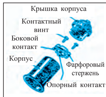
Рис. 77. Строение подвесного патрона.
