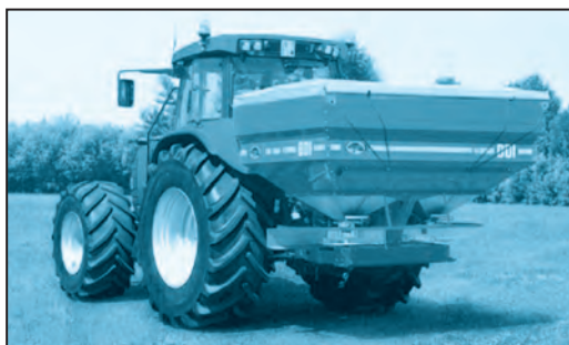
Рис. 10. Приспособление для внесения (посыпания) удобрений.
