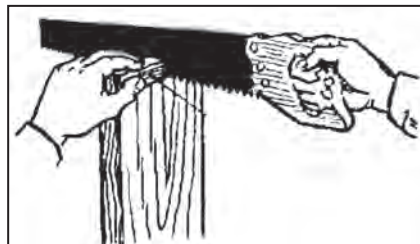
Рис. 46. Установка линии разметки.
