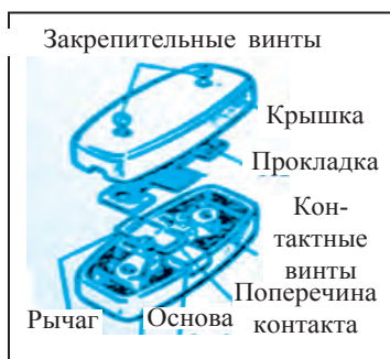
Рис. 75. Строение подвесного выключателя.
