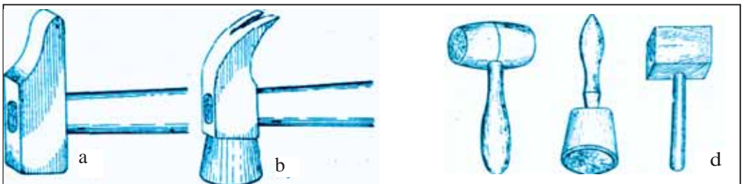
57-su'wret. Ag'ash ustashi'li'q balg'alari' ha'm toqpaqlar: a) kvadrat yen'seli; b) domalaq yen'seli balg'alar; d) ag'ash toqpaqlar.
