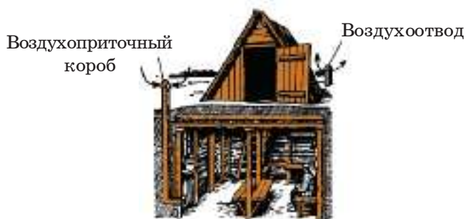
Рис. 21. Простейшее укрытие – подвал
