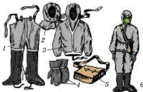
Рис. 15. Легкий защитный костюм: 1 — носки и брюки; 2 — подшлемник; 3 — рубашка с капюшоном; 4 — двупалые перчатки; 5 — мешок для хранения костюма; 6 — защитный костюм в боевом положении.
