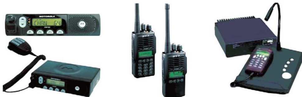
9-сурат. Азыркы күндө пайдаланылыш жаткан мобилдик, стационардык жана кол радиостанциялары.
