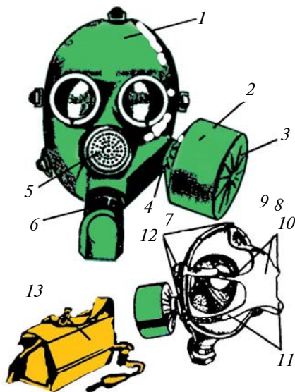
Расми 13. Ниқоби газии ГП-5: 1 — ниқоб; 2 — қуттии тозакундаи ҳаво; 3 — ғилофи аз трикотаж тайёршуда; 4 — даҳони найчаи нафасгирӣ; 5 — воситаи гапзанӣ; 6 — найчаи нафасбарорӣ; 7 — обтуратор; 8 — иртифӯъ; 9 — банди пешонӣ; 10 — банди чакка; 11 — банди тағи манах; 12 — банди дарозу кӯтоҳшаванда; 13
