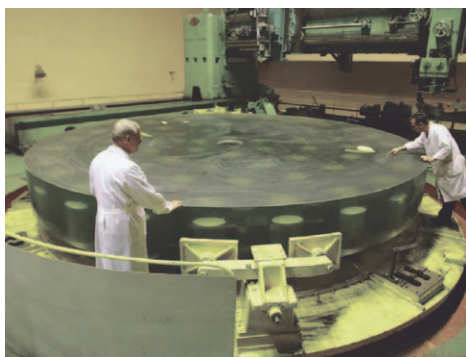
38-сүрөт. Диаметри 8 метрлүү телескоптун күзгүсүндө цехте жылмалоо жараяны.
