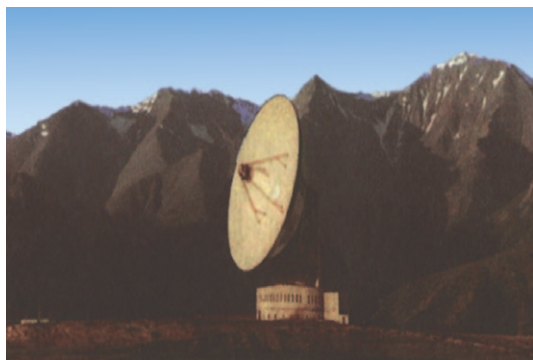
41-сурет. Жызақ облысы Замин таулары етегінде құрылған, металл айнасының диаметрі 70 метрлі радиотелескоп.
