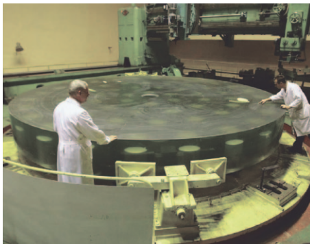
38-сурет. Диаметрі 8 метрлі телескоп айнасын цехта өңдеу үдерісі.
