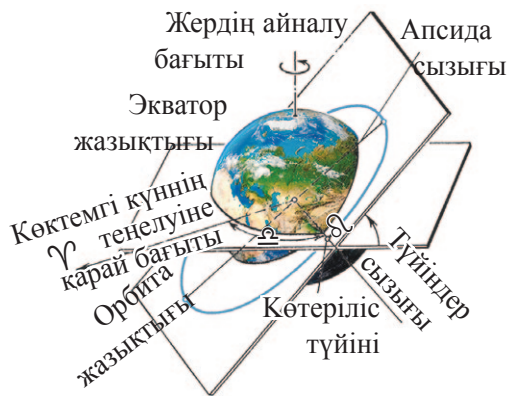
118-сурет. Жасанды серіктің орбиталық элементтері.
