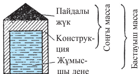
114-сурет. Ракета құрылысы сызбасы.
