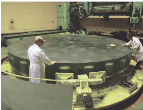
38-nji surat. Diametri 8 metrlik teleskopyň aýnasynyň sehde timarlanýşy.
