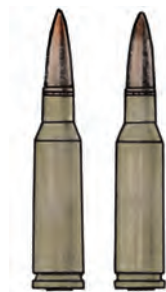
Рис. 89. Обычные и трассирующие патроны калибра 5,45 мм образца 1974 г.
