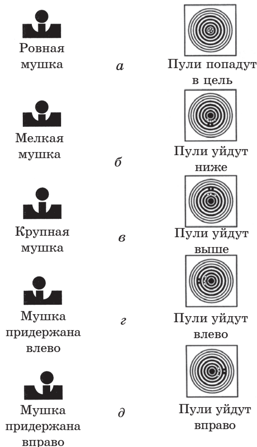
Рис. 126. Правильное прицеливание и ошибки при прицеливании: a — взятие ровной мушки и направление на цель; б — мелкая мушка; в — крупная мушка; г — мушка ушла влево; д — мушка ушла вправо
