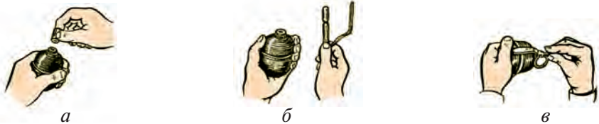
114-сүрөт. Майдалануучу кол гранаталарынын күжүрмөн абалы: a — пробканы бурап алуу; б — запалды алуу; в — запалды бурап орнотуу.
