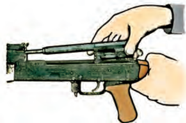
110-сүрөт. Затвор рамасын затвор менен бирге ажыратуу.
