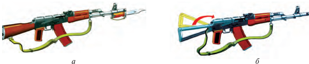
88-сүрөт. Калашников автоматынын жалпы көрүнүшү: а—жыгач кундактуу АК-74; б—кундагы бүгүлө турган АКС-74
