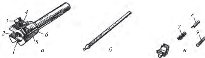
97-сүрөт. Затвор: а—затвор негизи; б—соккуч; в—ыргытуучу; 1—гильза үчүн кесме; 2—ыргытуучу үчүн кесме; 3—жетекчи бөртмө; 4—ыргытуучу огу үчүн түйнүк; 5—күжүрмөн бөртмө; 6—тосуучу бөртмө үчүн байлама кесме; 7—ыргытуучу пружинасы; 8—ыргытуучу огу; 9—кыстыргыч.
