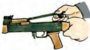
109-сүрөт. Кайтаруучу механизмди ажыратуу.
