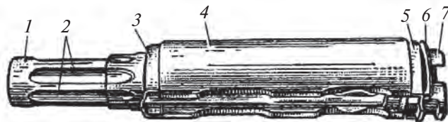
99-сүрөт. Газ трубкасы ствол каптамасы менен биргеликте: 1—газ трубкасы; 2—газ поршени үчүн багыттоочу кабыргалар; 3—алдындагы бириктиргич; 4—ствол үстү каптамасы; 5—арткы бириктиргич; 6—тумшук; 7—жалпак пружина.
