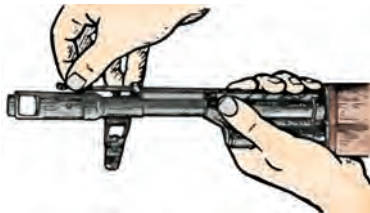
107-сүрөт. Шомполду ажыратуу.
