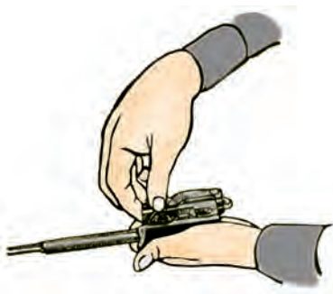
111-сүрөт. Затвор рамасынан затворду ажыратуу.
