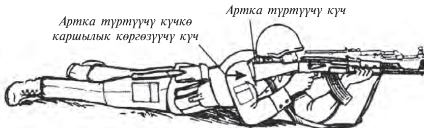
123-сүрөт. Атууда артка түртүүчү күч таасиринде курал ствол бөлүгүнүн жогоруга көтөрүлүүсү.
