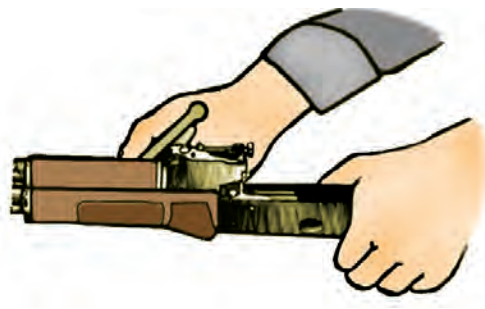
112-сүрөт. Газ трубкасын стол кундагынан ажыратуу.
