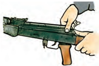
108-сүрөт. Ствол кутусунун капкагын ажыратуу.
