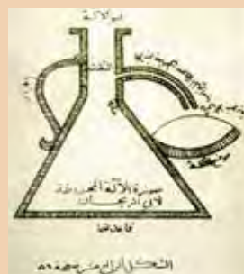
Сосуд, позволяющий определять точный объем вытесненной воды. XI век. Беруни
