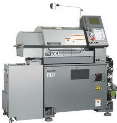
Расми 17. Станок хартоти замонавии коркарди металл – «Citizen RO-VI», ки ба тарзи автоматӣ идора карда мешавад.
