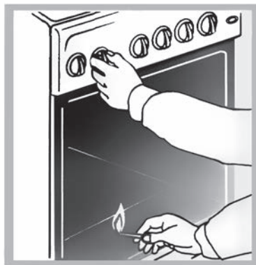
Расми 16. Намудҳои даргирондани плитаи газ: зер кардани тугма (а) бо ёрии тобдиҳак (б).
