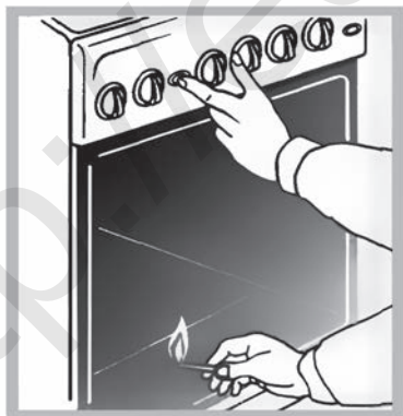
Расми 16. Намудҳои даргирондани плитаи газ: зер кардани тугма (а) бо ёрии тобдиҳак (б).
