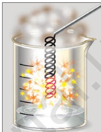
Рис. 26. Горение аммиака в присутствии катализатора
