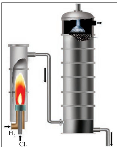
Рис. 17. Получение хлорида водорода в промышленности
