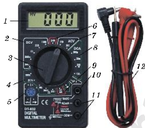
Рис. 22. Строение мультиметра марки DT-832: 1 – дисплей; 2 – измеритель силы постоянного тока; 3 – переключатель; 4 – измеритель сопротивления; 5 – гнездо проверки транзисторов; 6 – выключение; 7 – измеритель переменного тока; 8 – измерение тока; 9 – измерение постоянного тока; 10 – гнездо измерения тока 10 А; 11 – измерительные гнезда; 12 – измерительные провода (щупы)
