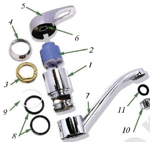
16-сурет. Бір рычагты смеситель қондырғысының құрылымы: 1 – металл корпус; 2 – картриж; 3 – картрижді пықтап ұстап тұратын гайка; 4 – декоративті қапқақ; 5 – смеситель тұтқасы; 6 – смеситель тұтқасы астында орналасқан квадрат пішініндегі ұстағыш; 7 – айналмалы тұмсық; 8, 11 – резиналы шенбер; 9 – фторопластикалық шенбер; 10 – аэратор (қорғау торы).
