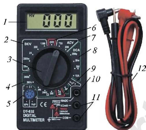
22-сурет. DT-832 маркалы мультиметрдің құрылымы:
