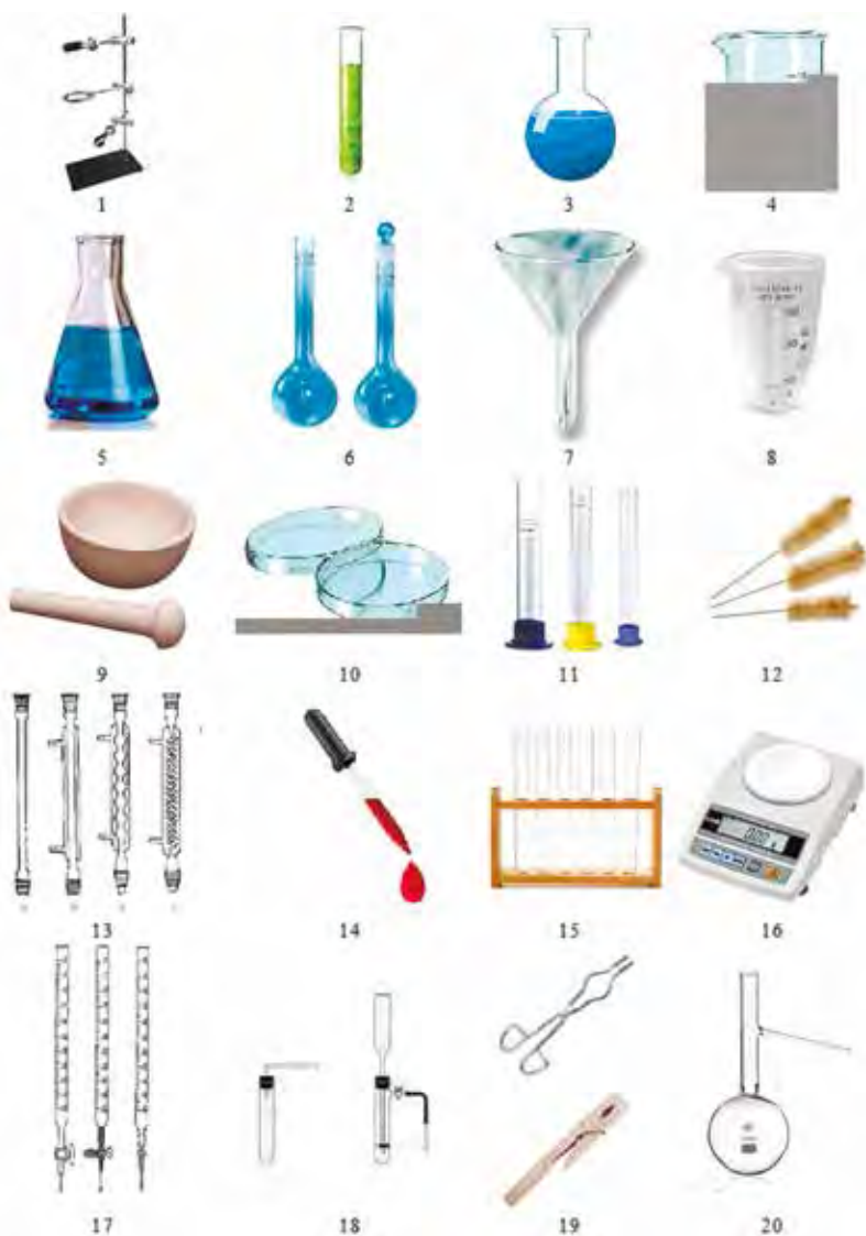
Расми 4. 1– штативи универсалӣ; 2– пробирка; 3– колбаи тагаш доирашакл; 4– стакани ченкунӣ; 5– колбаи конусшакл; 6– колбаҳои ченкунӣ; 7– воронкаҳои чинигин; 8– мензурка; 9– ҳовонча ва дастаки чинӣ; 10– зарфи Петрӣ; 11 – цилиндрҳои ченкунӣ; 12 – тозакунаки пробирка; 13 – сардкунанда; 14 – пипеткаҳо; 15 – нигоҳдорандаи пробирка; 16 – тарозуи электронӣ; 17 – буйреткаҳо; 18 – асбоби газгиранда; 19 – нигоҳдорақҳо; 20 – колбаи Вюре.
