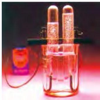
Расми 19. Дар электролизи об баробари 2 ҳаҷм гидроген 1 ҳаҷм оксиген ҳосил мегардад.
