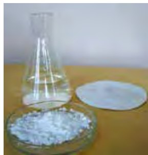
Ҳангоми реаксия гармӣ фурӯ бурда, ба таги колба қоғаз часпида мемонад.
