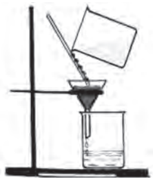
11-сурет. Сүзгіден өткізу әдісі.
