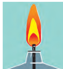
5-сурет. Спирт шамы жалынының құрылысы.
