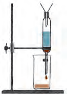
10-сурет. Бір-бірінде ерімейтін сұйықтықтарды айыратын құйғыш
