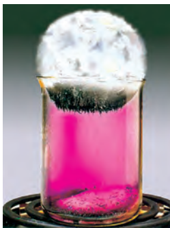
6-сурет. Йод түйіршіктерінің үстіңгі суық бетте жиналып, йод затын жасауы.
