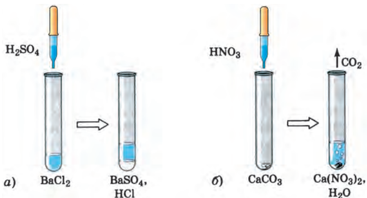
Рис.17. Образование осадка (а) и газа (б) в растворе
