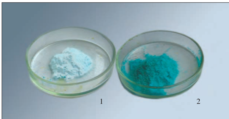
Рис.51. Образцы солей: сульфат меди \text{CuSO}_4 (1) и содержащий кристаллизационную воду медный купорос \text{CuSO}_4 \cdot 5\text{H}_2\text{O} (2).
