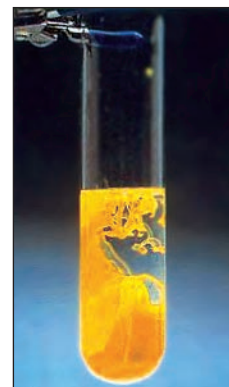
Рис.52. Образование осадка \text{AgI} при взаимодействии \text{AgNO}_3 с \text{NaI}
