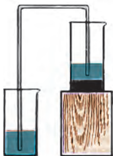
Рис.9. Получение чистой воды путем отстаивания
