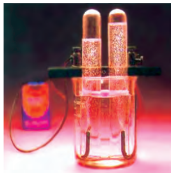
Рис.19. При электролизе воды образуется один объем кислорода и два объема водорода
