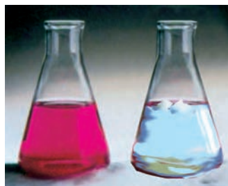
Рис. 41. «Сухой лед» и его взаимодействие с раствором щелочи, содержащим фенолфталеин, в результате которого происходит его нейтрализация и исчезновение окраски индикатора
