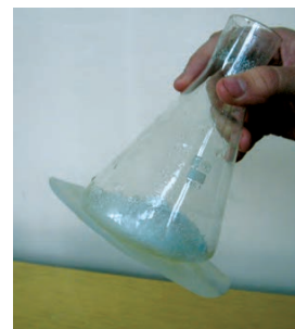
Reakciya waqtında jıllılıq jutılıp, kolbanıń astına qaǵaz jabisip qaladı.
