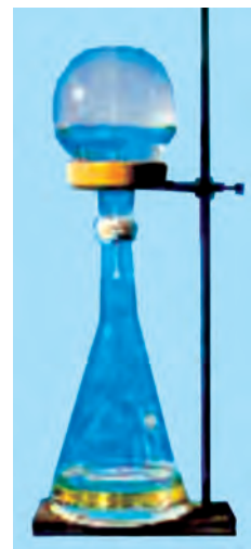
50-súwret. HCl gazınıń suwda erip, xlorid kislota eritpesin payda etiwı.
